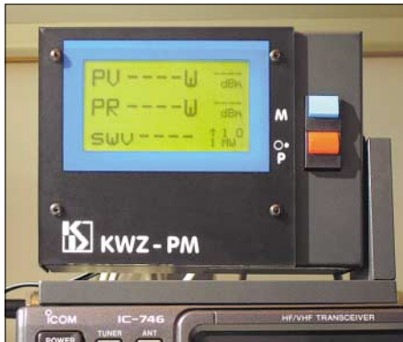
Bild 1: Die Anzeigeeinheit des KWZ-PM befindet sich in einem schwarz lackierten Edelstahlgehäuse mit vorgesetzter, gefräster Acrylglas-Frontplatte.
