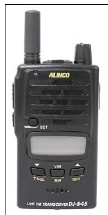
Bild 1: Alincos neuer Duobander DJ-S45 CQ für PMR446- und LPD-Sprechfunk. Hier die Variante mit Kurzantenne.
