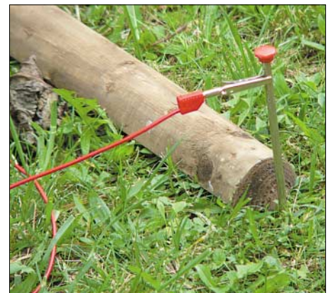
Bild 3: Um den Transport und Aufbau so einfach wie möglich zu halten, ist die Anschlussleitung mit Krokodilsklemmen befestigt.
