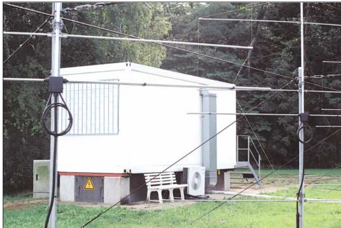
Bild 1: Sender, Empfänger und PCs zur Auswertung der VHF-Radardaten schützt ein Container.
