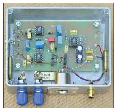
Bild 13: Dieses Gerät mit einem für den unteren ELF-Bereich modifizierten Instrumentationsverstärker eignet sich gut zur Erdantennenanpassung.
