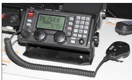
Der neue GMDSS-HF-Tranceiver M-801 von Icom scannt die DSC-Kanäle auf Kurzwelle und gibt Alarm, sobald ein Notruf empfangen wurde. Foto: DL1ABJ
