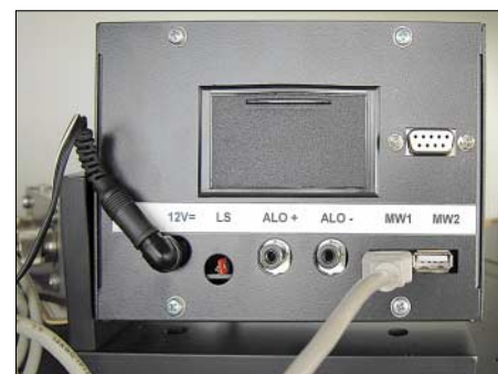
Bild 9: Alle Anschlüsse für die Anzeigeeinheit befinden sich auf der Rückseite: RS232-Schnittstelle, 12-V-Versorgungsspannung, Ladestecker für Akkumulatorbetrieb, ALO-Steuerungsausgang sowie zwei Anschlüsse für die Messwandler. Fotos: Autor
